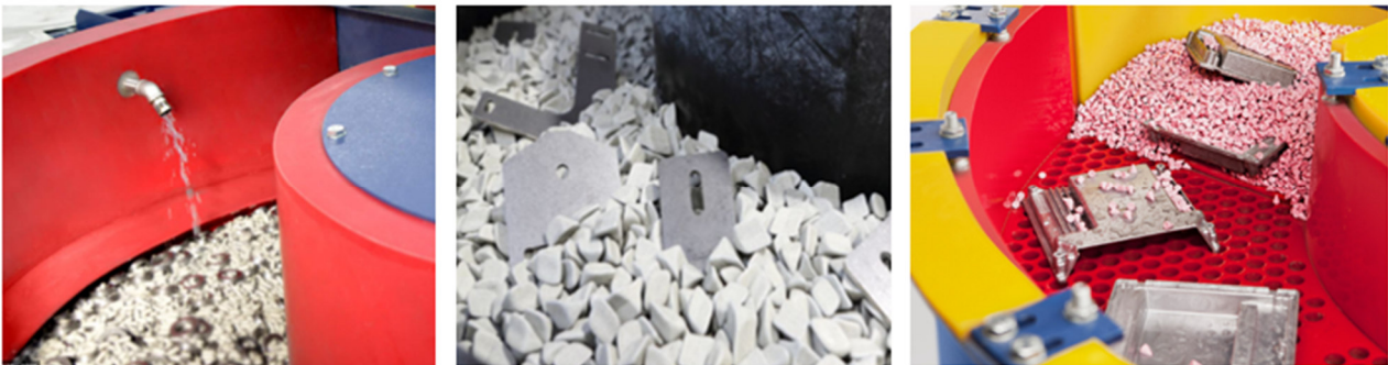
Beispielhafte Illustration des Gleitschleifens verschiedener Komponenten
